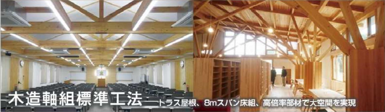
**木造軸組標準工法** — トラス屋根、8mスパン床組、高倍率部材で大空間を実現
