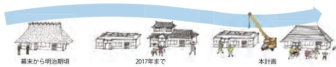
【講評】自然豊かな集落に建つ築150年の古民家の改修である。丁寧な建物調査とヒアリングの結果、入母屋造り瓦葺屋根の建物は当初寄棟造り茅葺屋根であったことが判明した。母屋の歴史的価値を残しながら現代の生活に即した改修をという建築主の要望に対し、集落の風景を担っていたかつての屋根の佇まいを地場の材を活かした現代的構法による大屋根で再現することが提案されている。新たに作る大屋根は地産杉 9m材（90mm×270mm）をジョイスト状に並べて構成し4枚の面を折板状に組み合わせて形成されている。それによって出来上がった無柱の小屋裏は屋根に入れられた全周スリットにより柔らかい光の差し込むギャラリー空間となっている。既存の建物に敬意を払いつつ、無理をすることなく新たな空間が生み出されている。新しいものと古いもの、守るべきものと新たに生み出すものが適度に調和されていて心地よい。（陶器）
