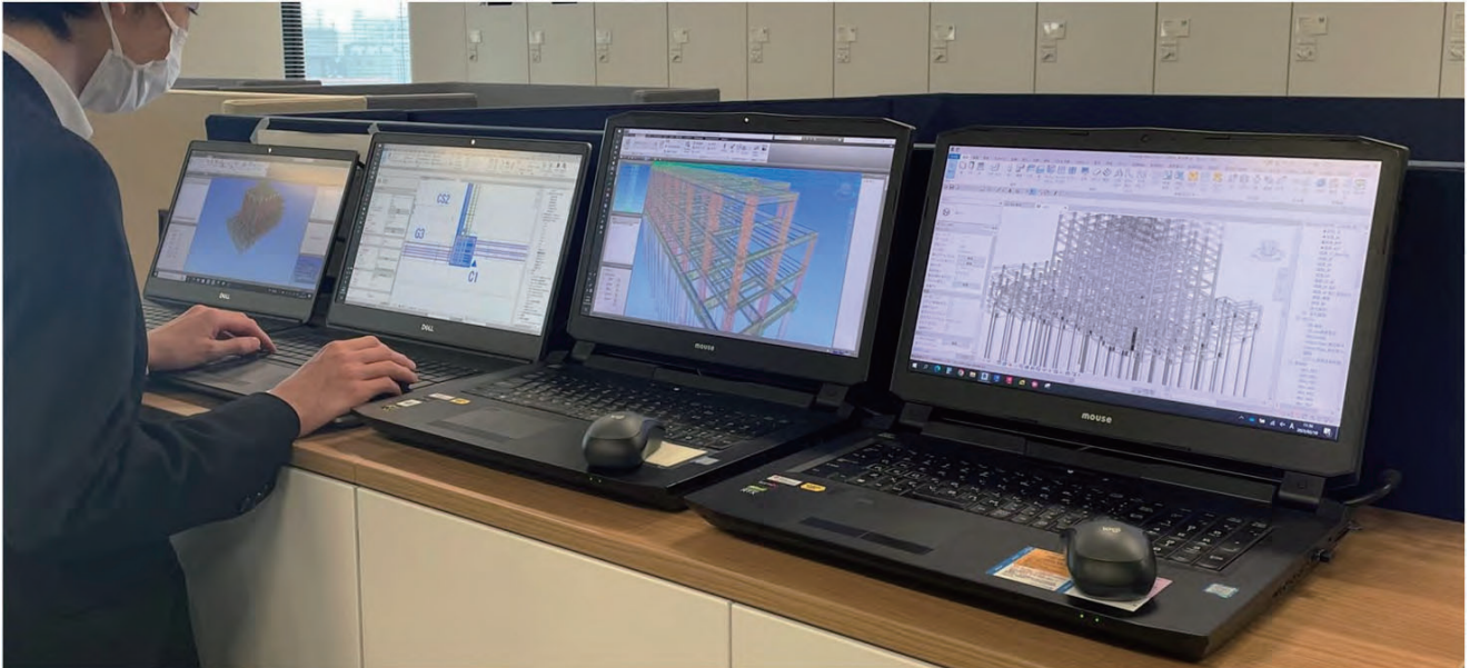
▲鉄筋/配筋BIMによる自動配置、自動配筋検査の実施状況（専用スペースを確保）
