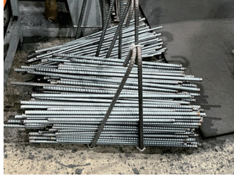
端材（加工機では端部を掴むため200ミリ以上の端材がでる）
