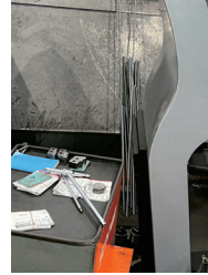
端材（加工機では端部を掴むため200ミリ以上の端材がでる）
