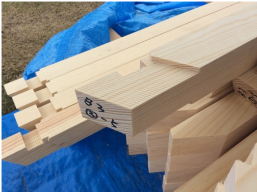
写真 3.3-3 エレテギア 家具用 NC 加工機により 高精度にプレカットされた接合部
